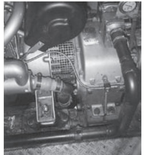
CENTAMAX-B im Hauptantrieb zwischen elastisch gelagertem Diesel Motor und starr gelagertem Schiffsgetriebe.
